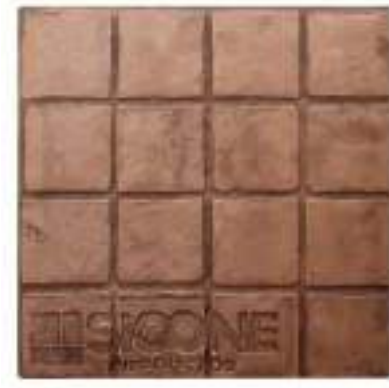
Color endurecedor: Tabaco Desmoldante: Café Oscuro Molde: Baldosa 15 x 15
