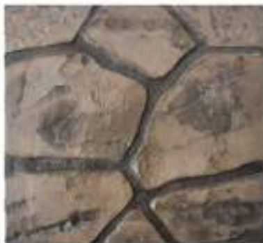
Color endurecedor: Tabaco Desmoldante: Negro Molde: Pichón
