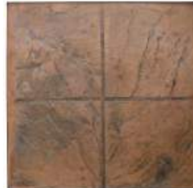
Color endurecedor: Tabaco Desmoldante: Negro Molde: Baldosa 30 x 30
