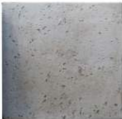
Color endurecedor: Gris Plata Desmoldante: Gris Molde: Piel Coquina
