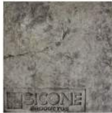
Color endurecedor: Travertino Desmoldante: Cafe Oscuro Molde: Piel de Elefante
