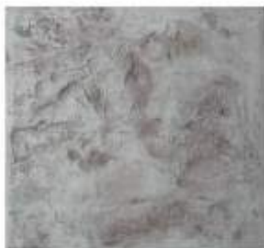
Color endurecedor: Avena Desmoldante: Chocolate Molde: Piel de Elefante
