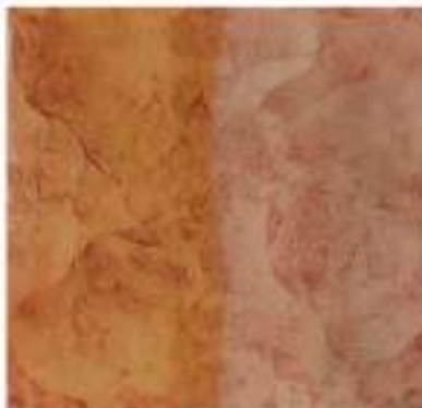
Color endurecedor: Beige y Rosa Desmoldante: Trigo Ultradelgado Molde: Piel Italiana
